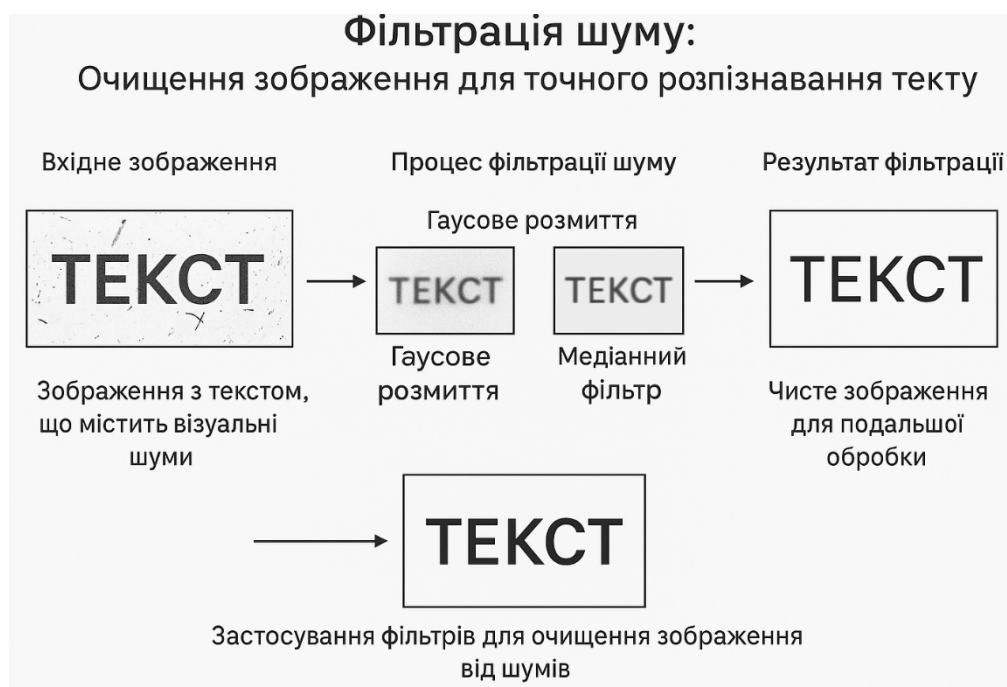
Рисунок 3.1 – Застосування Гаусового розмиття та медіанного фільтра
