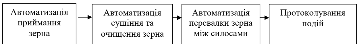
Рис. 3.1. Схема роботи АСУ (на прикладі зернопереробних операцій)
